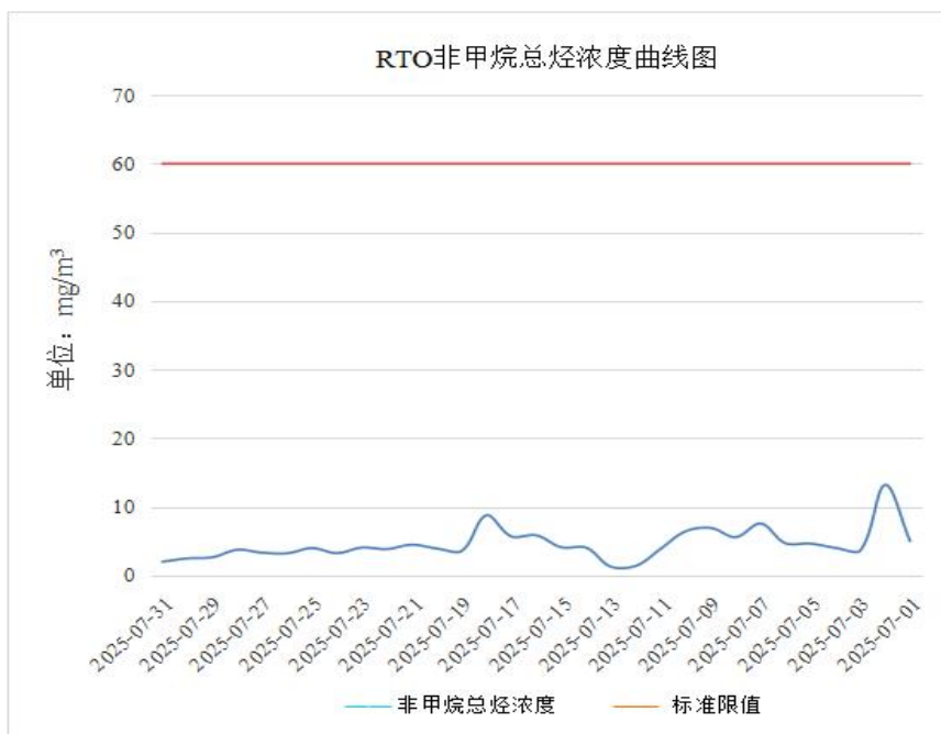
图 3.3.15.2-1 RTO 废气排放口 7 月非甲烷总烃在线监测曲线
