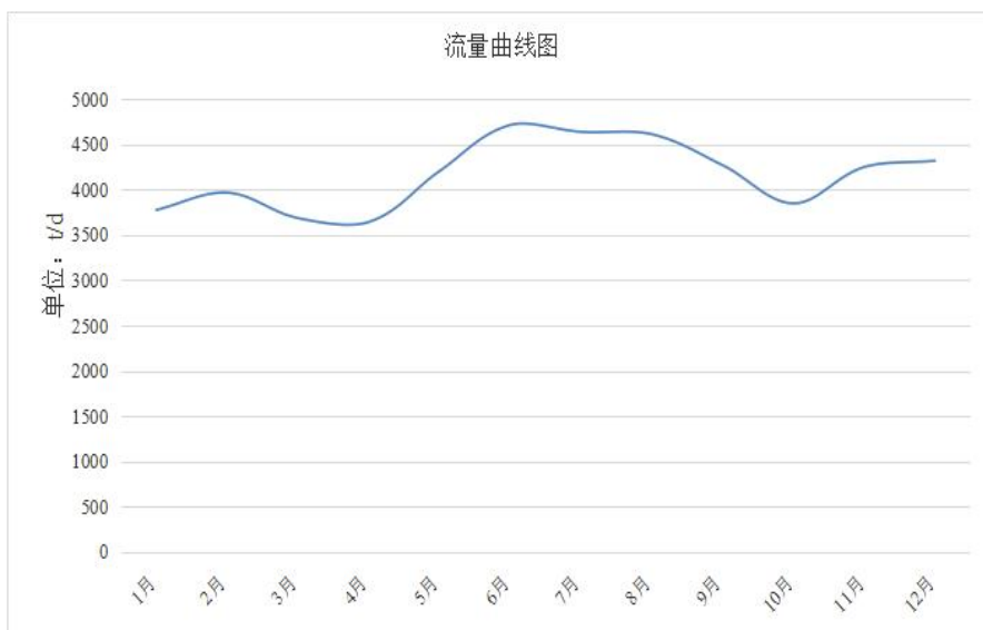
图 3.3.15.1-3 污水排放口 2025 年流量在线监测曲线
